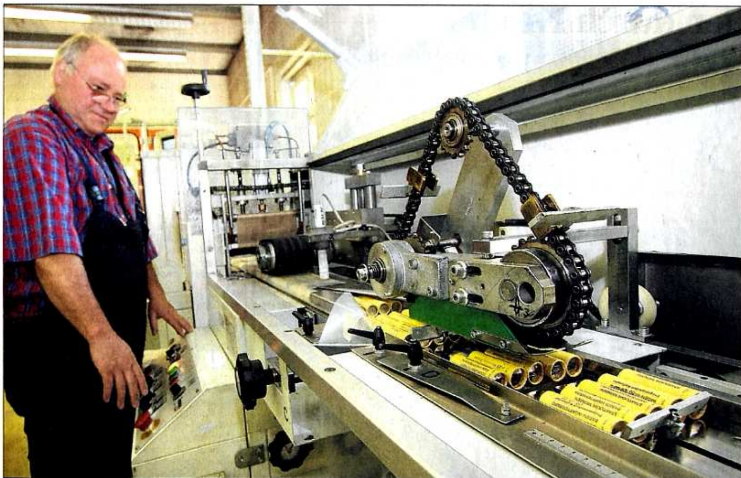
VERPACKUNGSWARE: Christian Hansch kontrolliert die Verpackungsstraße der Staatlichen Münze: Die prägefrische Ware wird zunächst gezählt, in Papierrollen gebündelt und zu Päckchen zusammengefügt. Über diese kommt Folie (Foto). Danach wird das Geld eingeschweißt. Fotos: jodo
